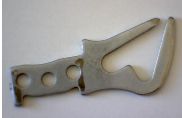
Рис. 1. Зуб батана одноименного механизма ткацкого станка СТБ
