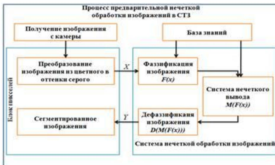
Рис 1. Алгоритм предварительной нечеткой обработки изображения.
