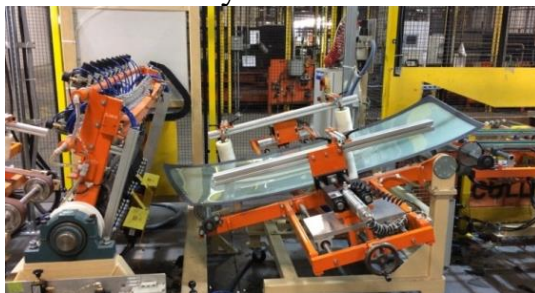
1- Magna Internationalda old oynak vakuumlash jarayoni.
