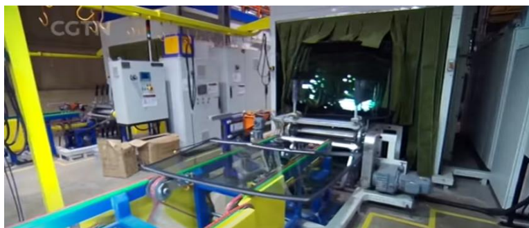
4-rasm. Fuyao Glassda old oynakni vakuumlashga tayyorlash jarayoni.
