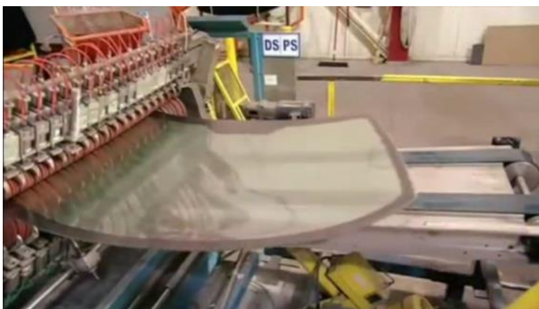
3-rasm. Pilkingtonda old oynak vakuumlash jarayoni.
