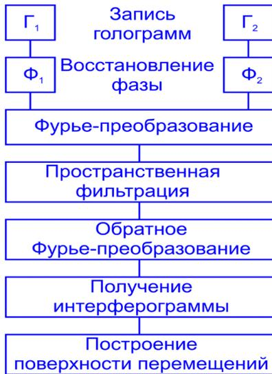
Рис1. Алгоритм принцип работы.
