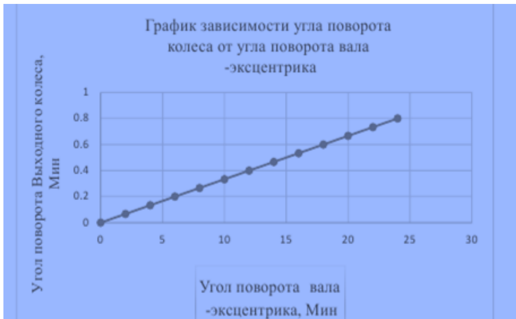
Рис 6. График зависимости угла поворота колеса от угла поворота вала - эксцентрика
