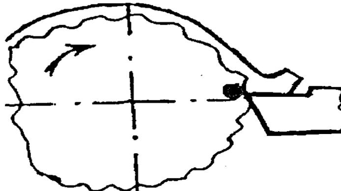
2.2.расм. Ишлов берилаётган юзага асбобнинг “учинчи тана” орқали таъсир этиш схемаси.
