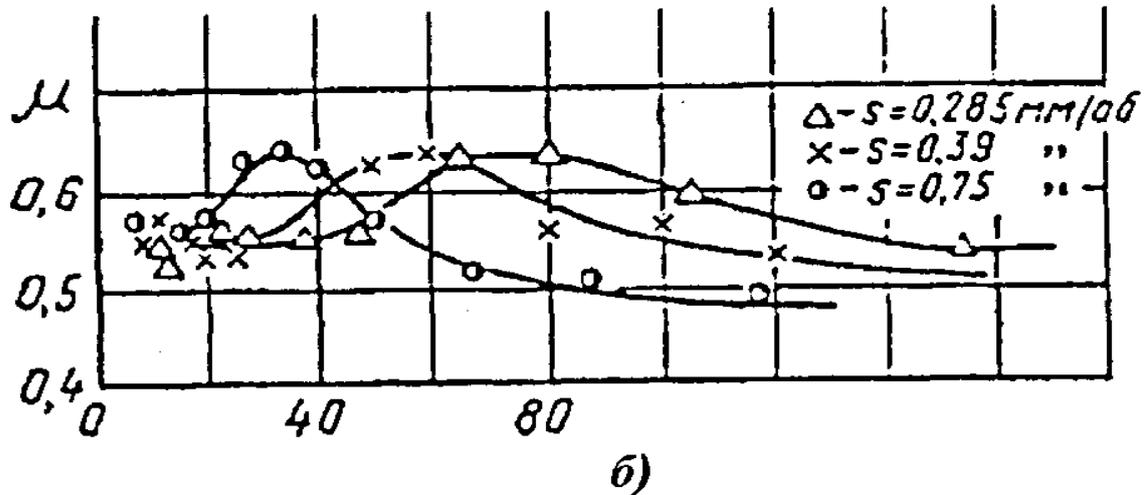
2.3.расм. Кесиш ва узатиш тезлигининг асбоб ва детал орасидаги ишқаланиш коэффитсиентига таъсири,
