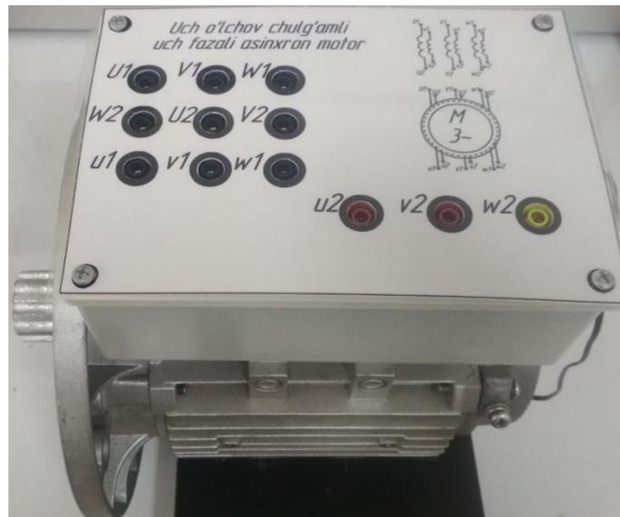
Рис. 2. Трехфазный асинхронный электродвигатель с тремя измерительными обмотками
