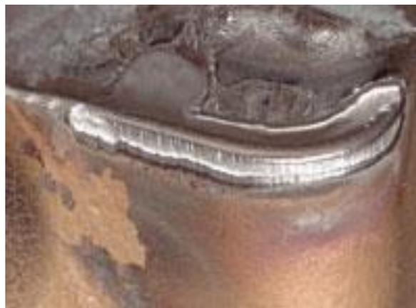
**Рис 1. Износ по задней поверхности**
