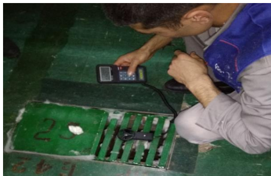
2-rasm. Chang miqdorini anemometr yordamida o‘lchash jarayoni.
