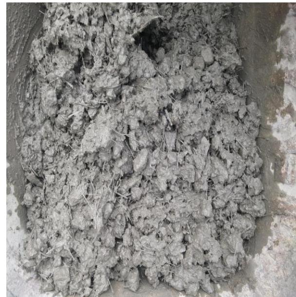
Tayyor bo‘lgan beton qorishmasining harorat ( $5-30^{\circ}\text{C}$ ), oquvchanlik (P 2 5-9 sm), zichlik ( $2200-2500 \text{ kg/m}^3$ ) kabi ko‘rsatkichlari talabga mosligi ta’minlangan holatida balka namuna uchun  $15 \times 15 \times 60$  va kub namuna uchun  $15 \times 15 \times 15$  qoliplarga joylandi.
