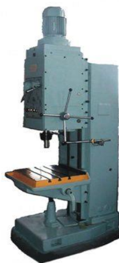
1.1-Rasm 2A135 vertikal parmalash dastgohi
