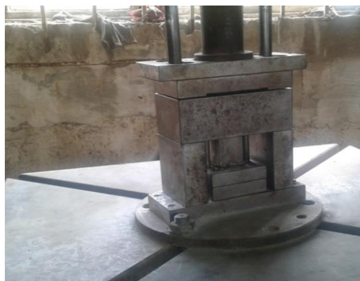
1-расм. Штампнинг пресс дастгоҳига ўрнатилган ҳолати
