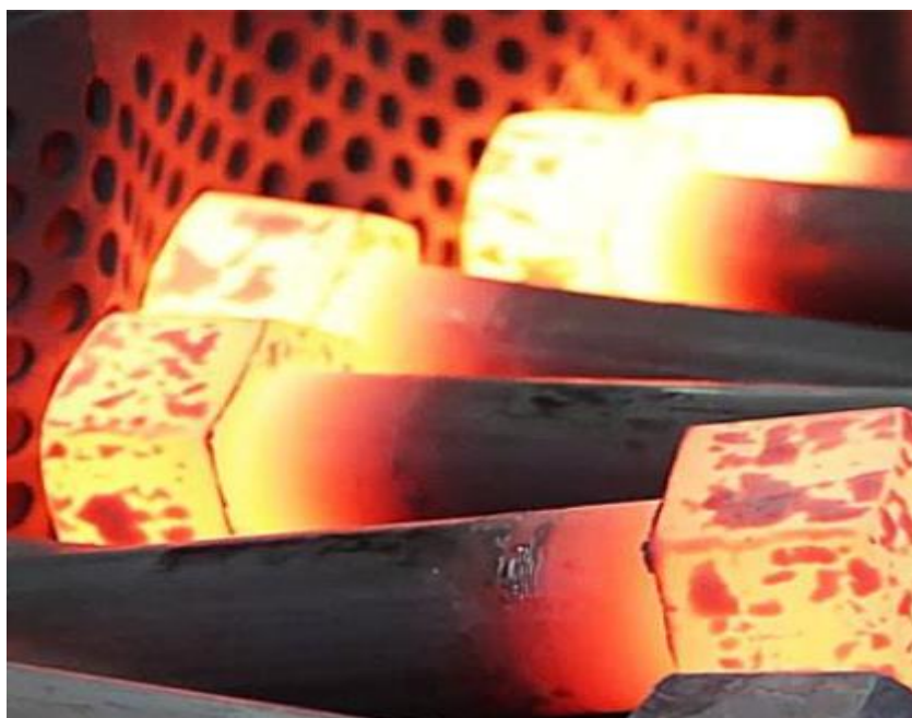
4-расм. Болтларни маҳаллий термик ишлаш.
