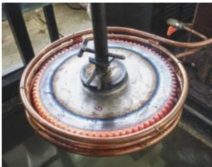
6-расм. Электр индукция ёрдамида маҳаллий термик ишлаш.
