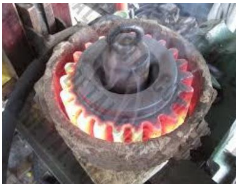
5-расм. Тишли қилдирак тишларига маҳаллий термик ишлов бериш.
