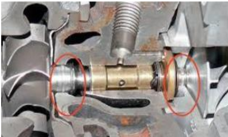
3-расм. Компрессор валининг ейилиши кўрсатилган.
