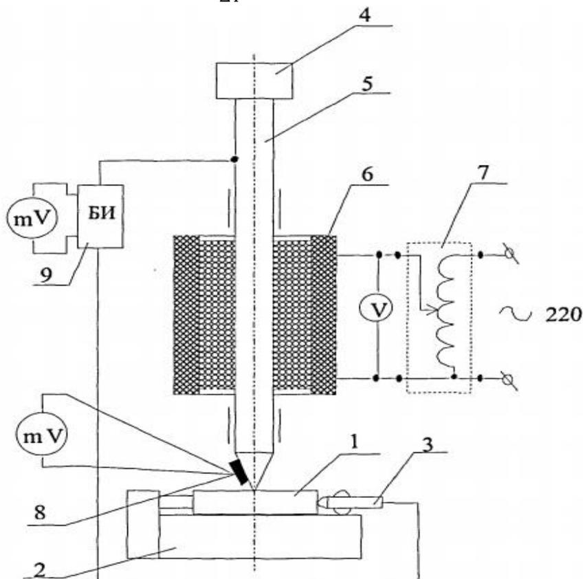
3.1-расм. Микро-термо-ЭХК усули билан қаттиқ қотишма пластиналарининг ейилган юзаларини ўрганиш учун ўрнатиш схемаси.
