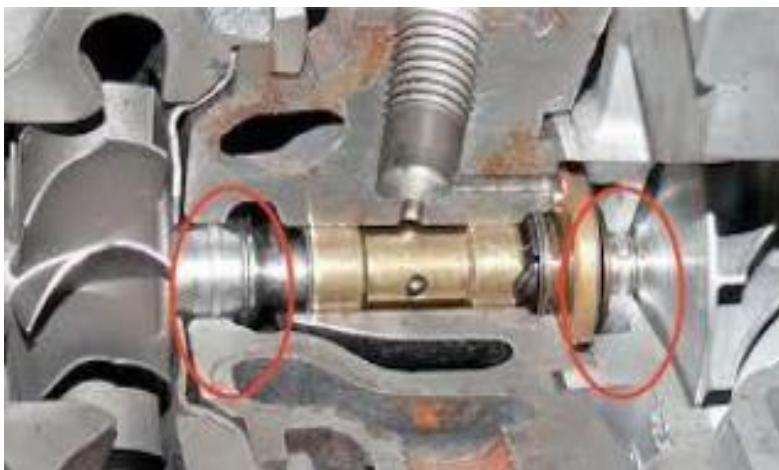
3-расм. Компрессор валининг ейилиши кўрсатилган.
