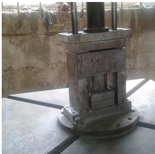
1-расм. Штампнинг пресс дастгоҳига ўрнатилган ҳолати
