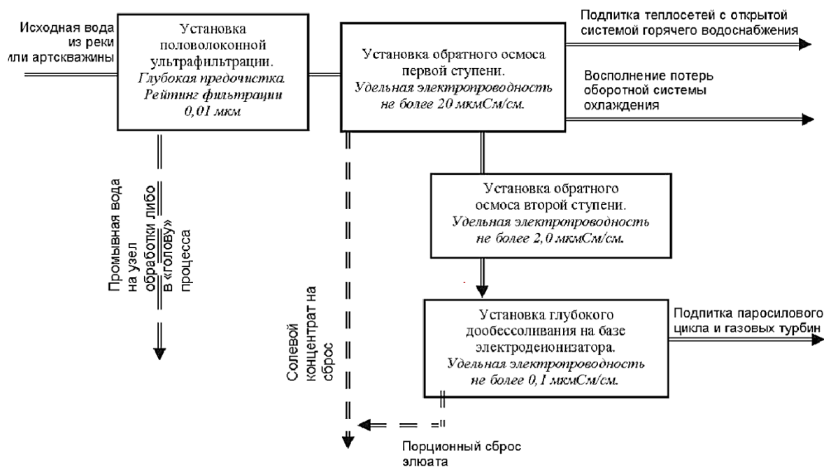
Рисунок 1 Принципиальная схема потоков обессоливающей установки с использованием электродеионизатора
