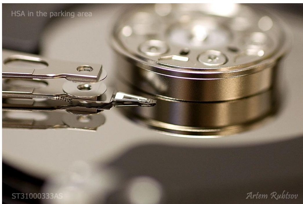
9-rasm. Magnit diskdan ma'lumotni o'quvchi va yozuvchi qurilma
