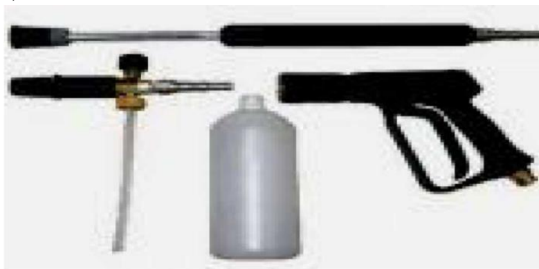
1-rasm. Qo'l bilan yuvishda ishlatiladigan suv sepgich (maksimal bosimi 160 Bar, suv sarfi 20 l/min; suvning maksimal harorat 60^{\circ}\text{C} )
